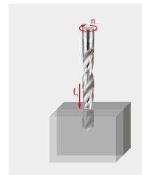
Avance por revolución ( $f_n$  en mm/rev) Dependiendo de las condiciones de trabajo puede ser necesario ajustar estos valores  $\pm$  25 %
