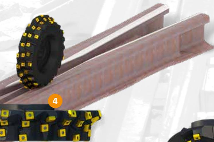
**5 – Fresa para mecanizar la parte superior de las puntas**
