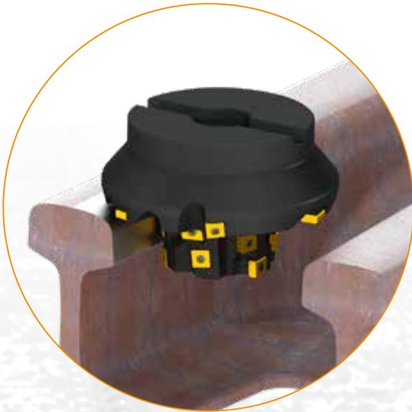
**Fresa de perfil especial para mecanizar la cabeza del raíl**
