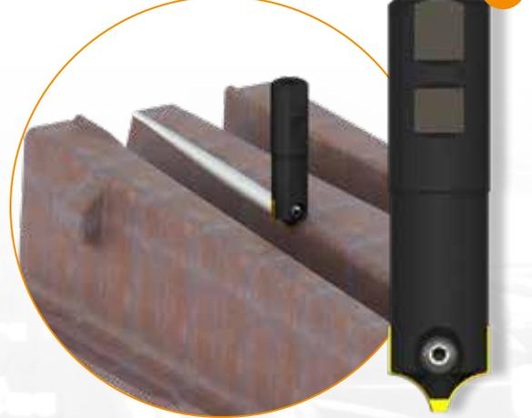
**1 – Fresa de tipo en eje para redondeado de vértices**
